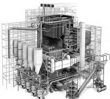
Vodotrubné kotle na tuhá paliva
